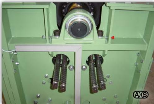
Seitliche Entnahme der Flexstäbe
