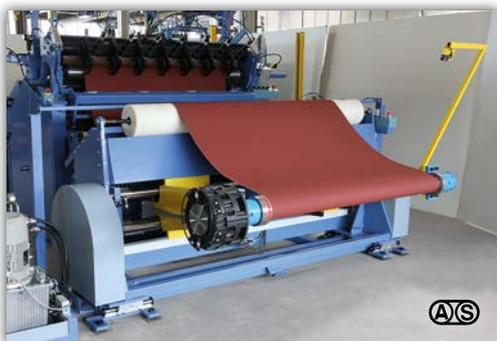
Optional erhältlich: Achslose Abrollstation Typ 366 für ergonomisches Rollenhandling
